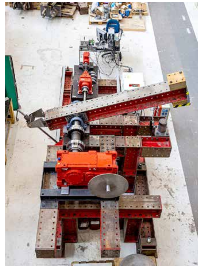
De imposante en uit de kluiten gewassen meetopstelling bij de TU Delft maakt het mogelijk om de rekenmodellen in de praktijk te testen, zonder last te hebben van schaal-effecten.
