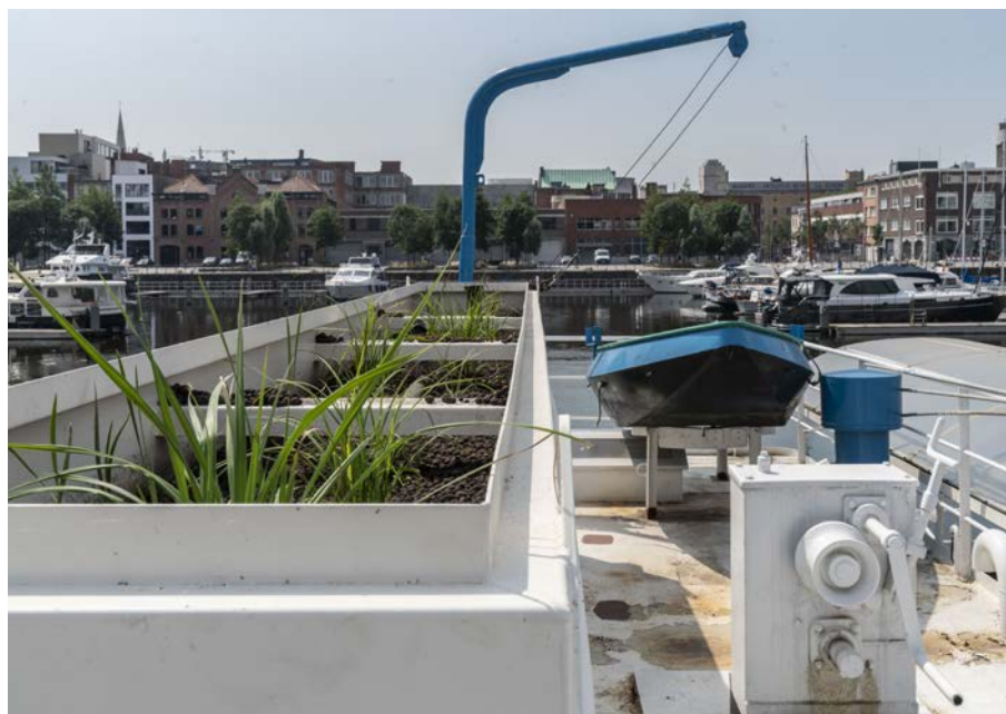
Bak met belucht rietveld op de achtersteven. Water uit deze bak komt in de tanks. De bak op de voorzijde loost op de haven.
