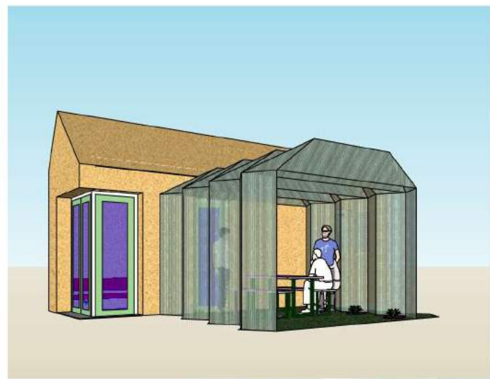
Het Tiny house op de trailer, ingevouwen serre is zichtbaar. Voor het badkamer raam is het zomernachtventilatie rooster dicht.
