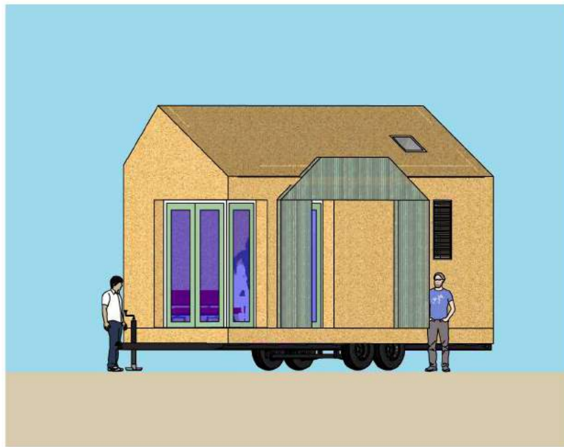
Het Tiny house op de trailer, ingevouwen serre is zichtbaar. Voor het badkamer raam is het zomernachtventilatie rooster dicht.
