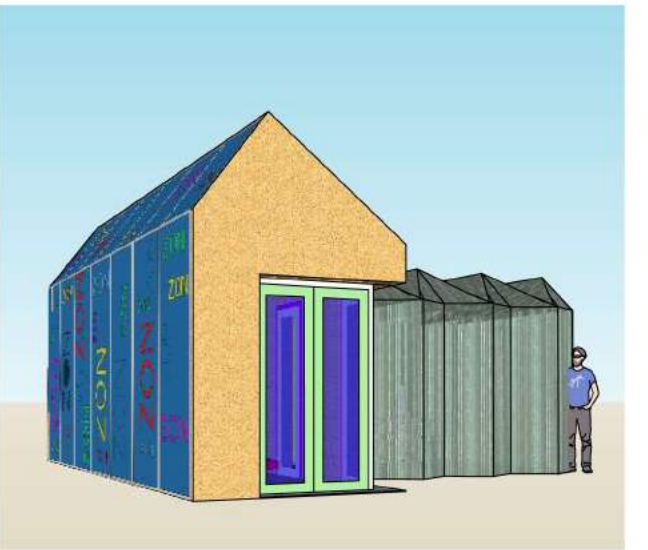
Het Tiny house staat nu op de schroefpalen. De serre is een onverwarmde binnenruimte. De serre is uitklapbaar. Het is de bedoeling dat hij vooral wordt gebruikt als het zonnig is. Dan zal hij snel op temperatuur zijn.
